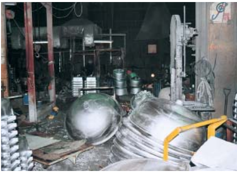
高速フレーム熔射技術で作る業務用IH釜
